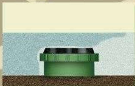
Установка мины в снег на поверхность грунта при снежном покрове до 10 см
