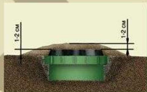
Установка мины в грунт и маскировка рыхлым грунтом.
