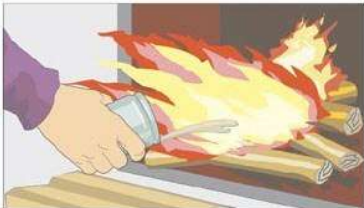
Применение для розжига пачек легко воспламеняющихся и горючих жидкостей, выпадение угля, трещины в кладке, возгорание сажи в дымоходах
