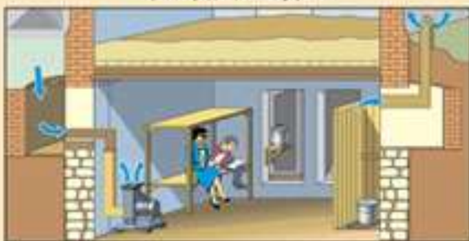
Подвал одноэтажного здания, приспособленный под противорадиационное укрытие
