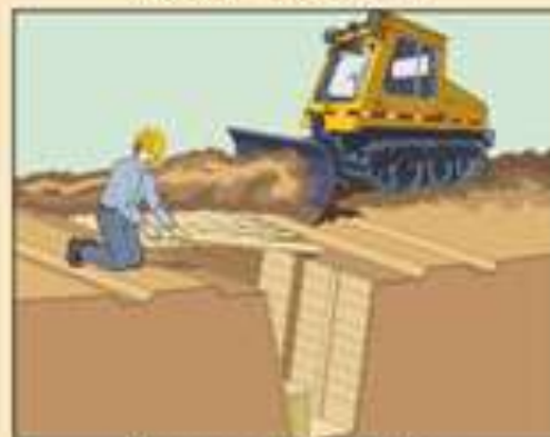
Оборудование перекрытой щели
